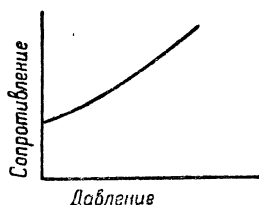
Рис. 69. График, показывающий направление кривизны почти всех кривых в случае увеличения сопротивления с давлением.
